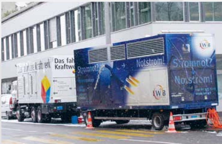
Mit dieser mobilen Notstromgruppe konnte während einer Kabelsanierung die Energieversorgung eines Dorfteils durchgehend gewährleistet werden. Baden 2005.
